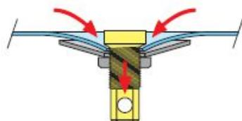
Werkzeug um dicke Kanalwände trichterförmig vorzuformen, da Ablaufstutzen brechen könnten.
